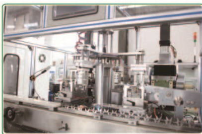
A4WZ1端面三轴联动钻孔四工位全自动平衡机
