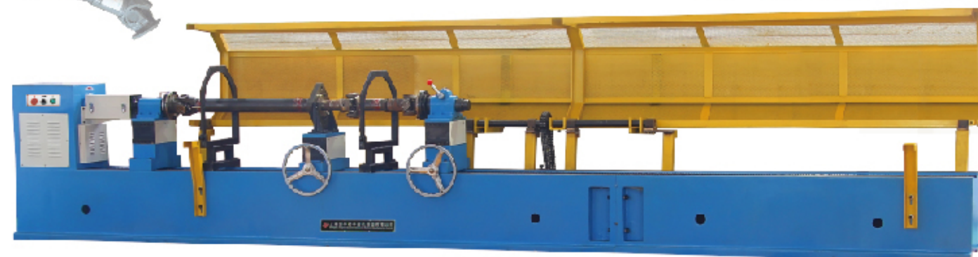
PHCW-200T型传动轴平衡机 (两节传动轴)
